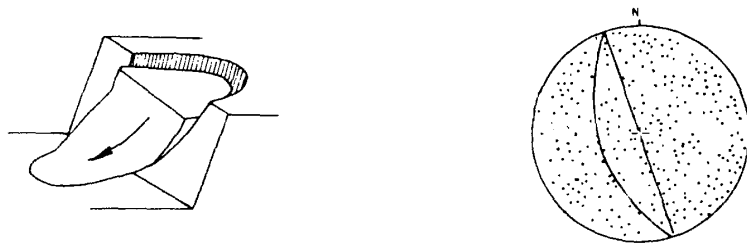
Fig. 1 Scivolamento subcircolare in roccia fratturata con discontinuità non isorientate (“random”)
